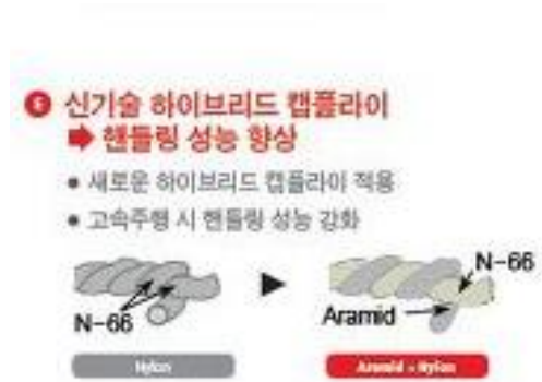
그림 17. 아라미드를 나일론과 혼용한 아라미드 타이어코드 예시
