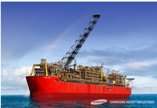
그림1. 해상플랜트: 한정된 공간&무게: 설계&건조 난이도 높음
